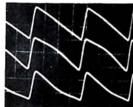
Bild 13. Ausgangssignale eines Gegentaktverstärkers mit Transistoren unterschiedlicher Kenndaten
