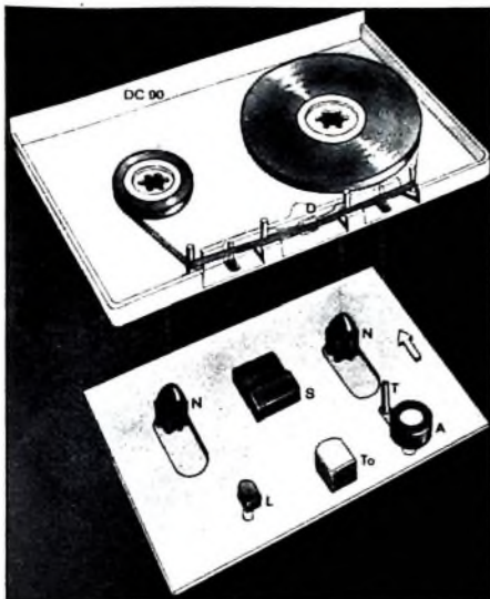
Bild 1. Schematische Darstellung der Cassette „DC 90“ (oben) und des Antriebssystems sowie der Magnetköpfe (unten); A Andruckrolle, D Blattfeder mit Filzstück, L Löschkopf, N Antriebsnocken, S Auswerfer, T Tonwelle, To Tonkopf
