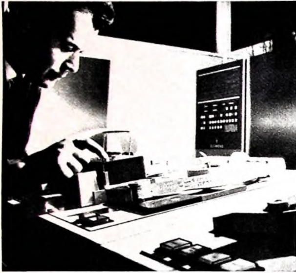
Die Siemens-Datenverarbeitungsanlage „3003“ als Satzrechner; links: die Geräte für die Eingabe des Endlos-Lochstreifens und für die Ausgabe des satzreifen Lochstreifens; rechts: die Zentraleinheit der Datenverarbeitungsanlage und der Blattschreiber, mit dem der Operator seine Anweisungen an den Rechner durchgeben kann
