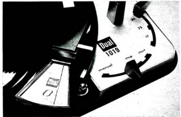
Bild 11. Messung der Skating-Kraft während der Abtastung mit dem „skate-O-meter“
