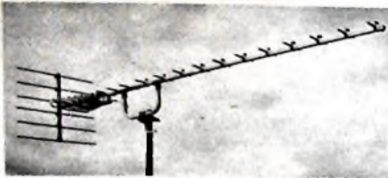
Bild 17. 28-Element-UHF-Superbreitbandantenne von VEB Antennenwerke, Bad Blankenburg/Thür.
