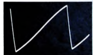
Bild 4: Spannung am Widerstand R19 (0,67 V eff )
