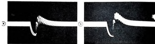
Bild 16. Einschwingen der Oszillatordphase in einem APC-Referenzträgergenerator: a) mit Auslastung wie NTSC, b) mit Auslastung nach Bild 15
