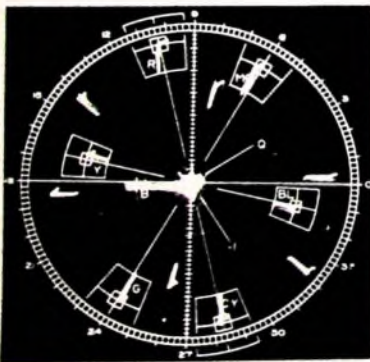
Bild 26. Vektorskopfbild eines Farbbalkentests mit eingeführter Störphasenmodulation nach PAL-Korrektur; a) ungestörtes Signal, b) Signal mit 36^\circ Phasenmodulation, c) Signal nach Einschaltung des Phasenkorrektors (Amplitudenfehler), d) Signal nach Einschaltung von Phasen- und Amplitudenkorrektor (Signal fehlerfrei)
