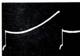
Bild 2: Sägezahnspannung (10,5 V eff ) am Emittieren von T3
