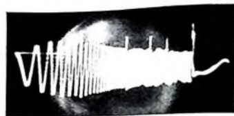
Bild 10. Wiedergabecharakteristik eines guten Magnetsystems
