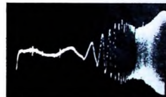
Bild 4. Abtastfrequenzgang mit einem Magnetsystem ohne Entzerrungsverstärker; man erkennt zusätzliche Resonanzüberhöhungen bei etwa 1 und 9,5 kHz
