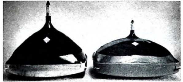
Bild 4. Größenvergleich der Farbbildröhre A 63-11 X mit der Schwarz-Weiß-Bildröhre A 65-11 W
