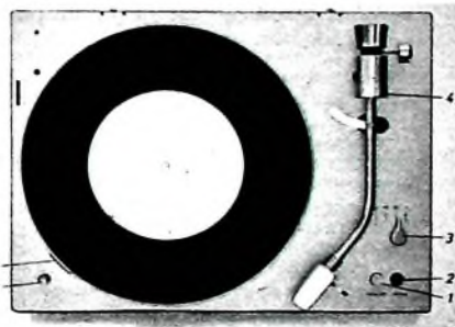
Bild 2. Oberseite des „PS 1000“ mit Bedienelementen: 1 Tonarm ablesen — heben, 2 Antrieb Ein — Aus, 3 Drehzahlwahl, 4 Auflagekraft-Einstellung, 5 Siroboskop, 6 Drehzahlfeineinstellung
