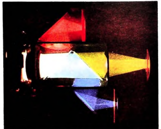
Bild 39. Wirkungsweise des optischen Farbteilers
