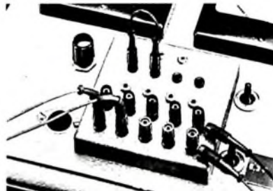
Bild 1. Die neuen Miniatur-Steckverbindungen von Hirschmann
