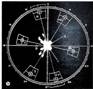
Vektoroszillogramm: a) Farbbalkensignal. b) Farbdipositiv
