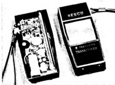
Ansicht der 5-Transistor-Funksprechgeräte von Resco (Conrad)
