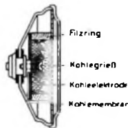
Bild 3. Prinzipaufbau des Kohlemikrofons
