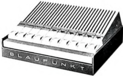
Bild 1 Hauptstelle der Blaupunkt-Wechselsprechanlage
