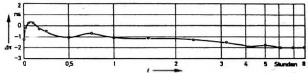
Bild 12. Verhalten der Verzögerungszeit der Leitung bei einem Temperatur sprung von 25 °C auf 45 °C
