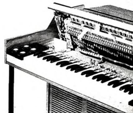
Die Manuale der „GM 755“ sind schwenkbar. Hier ist das obere Manual hochgeklappt, so daß alle Einzelteile leicht zugänglich sind
