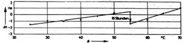
Bild 11. Temperaturgang einer Ultraschall-Verzögerungsleitung (vor jeder Messung wurde die Leitung eine Stunde auf gleicher Temperatur gehalten)
