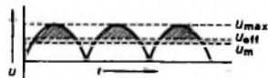
Bild 3: Kurvenform der Spannung hinter dem Gleichrichter mit arithmetischem Mittelwert U_{\text{eff}} , Effektivwert U_{\text{eff}} und Scheitelwert U_{\text{max}}
