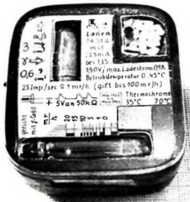
Bild 4. Ansicht des 66 mm x 58 mm x 30 mm großen Strahlungsmessgeräts
