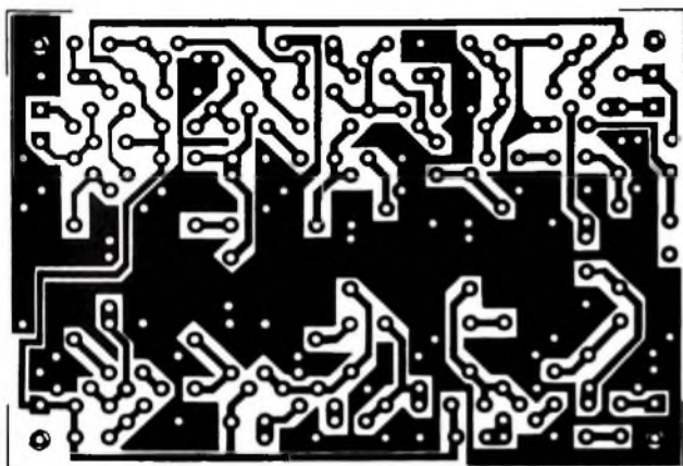
Bild 5. Geätzte Platine im Maßstab 1:1 (links) und Bestückungsplan (rechts) des ZF-Verstärkers
