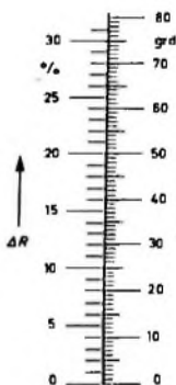
Bild 1. Nomogramm zum Ablesen der Übertemperatur T_0 als Funktion der prozentualen Widerstandsänderung \Delta R .
