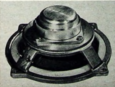
Der Tieftonlautsprecher „146 KT“ (VEB Elektroakustik Leipzig) hat auf Grund einer ungewöhnlich schweren Membran und eines neuartigen Gewebescharniers eine sehr niedrige Grundresonanzfrequenz
