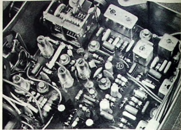
Bild 5. Einzelteilanordnung des Senders und des Modulatorteils
