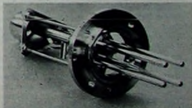
Bild 4. Elektrostat. Modulationslinse des Eidophors mit Aperturblende und Anode
