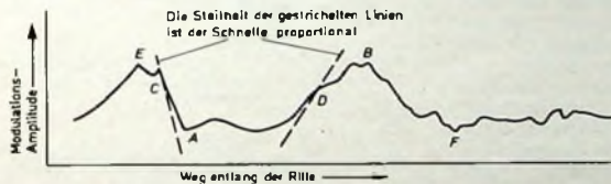
Bild 2. Längsschnitt durch eine Rillenflanke
