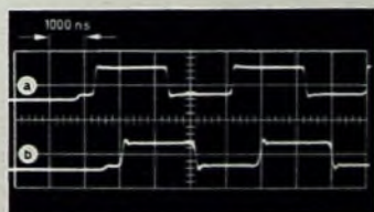
Bild 5. Rechtecksignal; a) vor und b) nach dem Passieren der Verzögerungsspule
