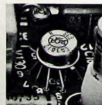
Teilsicht der Ton-ZF-Verstärkerplatte mit dem Verstärkerbaustein CA 3012 in Blaupunkt-Empfängern
