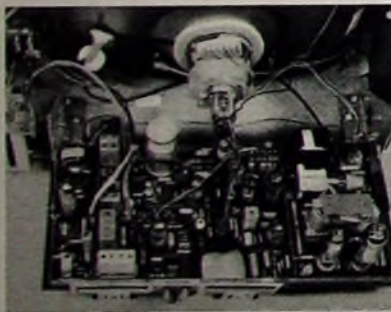
Herausgeklapptes Fernsehempfängerchassis „D 6“ im Fernseh-Tischgerät „D 19 T 700“ von Philips
