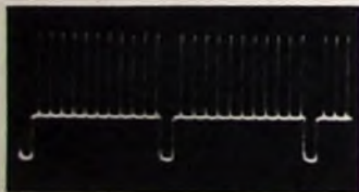
Bild 3. Oszillogramm des Konvergenzmustersignals des PAL-Regenbogengenerators
