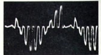
Bild 14. Farbdifferenzspannung -(U_B - U_Y) bei RGB-Ansteuerung der Farbbildröhre
