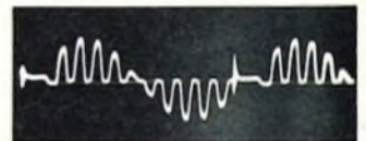
Bild 15. Farbdifferenzspannung -(U_G - U_Y) bei RGB-Ansteuerung der Farbbildröhre
