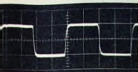
Bild 10. Ausgangsspannung U_A des unbelasteten Diskriminators; \varphi = 90^\circ ; Zeitachse 30 \mu s/Tlg.
