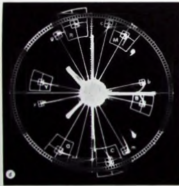
Bild 1 Testbild-Vorschlag 1: a) Schirmbildschema, b) Schirmbild, c) Pegeloszillogramm, d) Vektoroszillogramm
