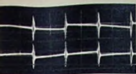
Bild 9. Verlauf der Sägezahnspannungen U_{C11} (obere Kurve) und U_{C21} (untere Kurve) am Diskriminator, Zeitachse 30 \mu s/Tlg.
