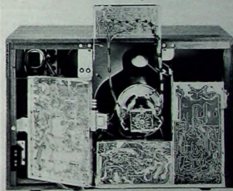
Die Chroma-Platte (links) des Metz-Chassis ist schwenkbar; rechts das L-förmige Klappchassis mit den Leiterplatten für Ablenkung und Hochspannungserzeugung; oben die schwenkbare, von vorn bedienbare Konvergenz-Einstellplatte (s. auch Titelbild)
