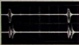
Bild 6. Gute (oben) und fehlerhafte (unten) Farbsynchronimpulse; 20 V/Tg. und 64 \mu s/Tg.
