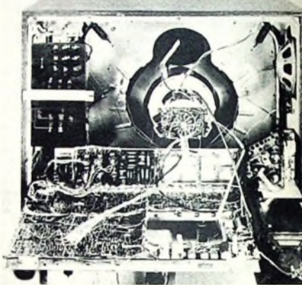
Das Philips-Chassis kann ganz herausgeklappt werden; die Einstelleinheit für die Konvergenz ist flach an der linken Gehäusewand angebracht (im Foto ist sie für Demonstrationszwecke um 90° gedreht)
