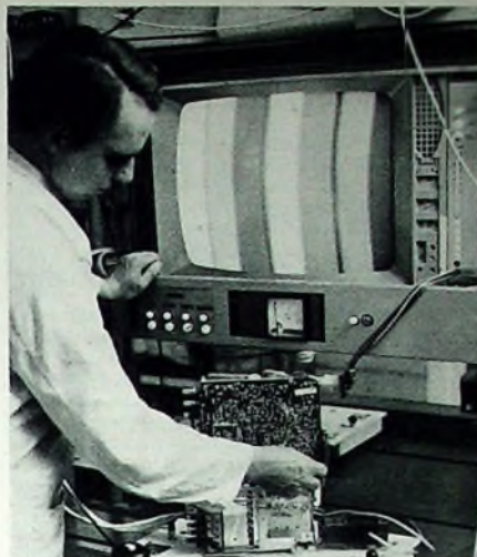
Das schmale Farbverstärker-Chassis der Kuba-Imperial-Empfänger (über die bereits im Heft 4/1967, S. 122-123, ausführlich berichtet wurde) ist leicht ein- und auszubauen; es sitzt in einer Federsperre neben der Bildröhre. Links: Einstellung des 7,8-kHz-Verstärkers des Chassis während der Fertigung
