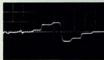
Bild 3. (G—Y)-Signal am Wehneltzylinder (für Farbbalken)
