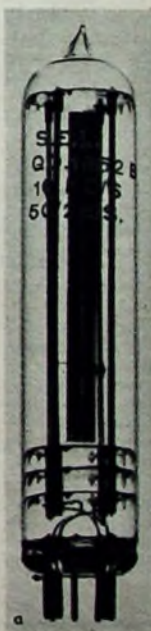
Bild 19. Lötquarz im Subminiaturhalter aus Metall (DIN-Norm 45 116; USA-Norm HC-18/U) [7].
