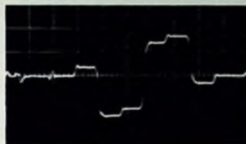
Bild 2. (R—Y)-Signal am Wehneltzylinder (für Farbbalken)
