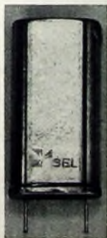
Bild 18. Steckquarz im Miniaturhalter aus Metall (DIN-Norm 45 111; USA-Norm HC-13/U) [7].
