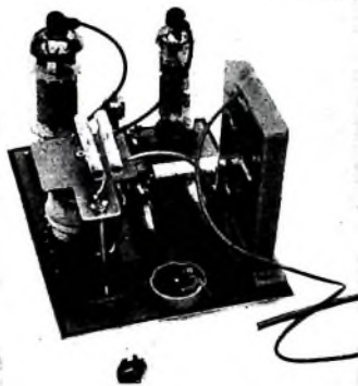
Erzeugung des Horizontalablenkstroms und der Hochspannung mit nur einem Zeilentransformator; die Vervielfacherkaskade „TVK 1“ (rechts) liefert 25 kV Hochspannung und die Fokussierungsspannung für die Farbbildröhre (Siemens)
