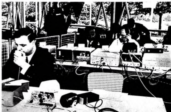
Oben: Blick auf die 1-kW-SSB-Station für Überseeleink mit Steuergerät für den 3-Element-Drehrichtstrahler
