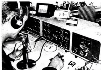
Oben: Blick auf die 1-kW-SSB-Station für Überseeleink mit Steuergerät für den 3-Element-Drehrichtstrahler
