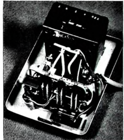
Bild 3 Innenaufbau mit Transformator (oben im Bild) und Druckastensaggregat am Frontdeckel des Gehäuses (unten im Bild)
