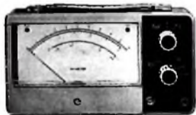
Transistor- Breitband- Millivoltmeter 1 mV - 300 V, Frequenz- gang 10 Hz - 1 Mhz \pm 0,5 dB DM 219,-
