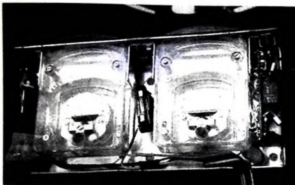
Bild 5. Blick durch die Windschutzscheibe in das Gerät bei abgenommener Abdeckhaube; in der Mitte zwischen den Instrumenten erkennt man die Skalenlampe
