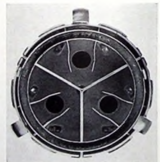
Bild 2. Blick auf den Konvergenztopf eines Farbbildröhrensystems
