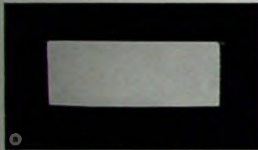
Schirmbildaufnahme des 42 \mu s breiten Weißbalkens
