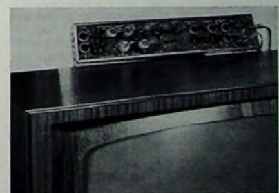
Bild 17 (unten). Aus dem Gehäuse herausgeklappte Konvergenzplatte bei einem Blaupunkt-Farbfernsehempfänger
