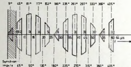
Bild 7. Phasenänderung der Farboszillatofrequenz (bezogen auf die Farbträgerfrequenz) während einer Zeilenperiode
