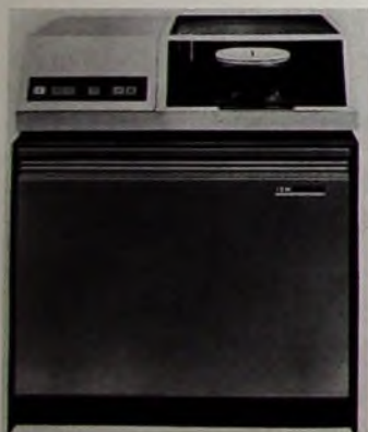
Mehrere dieser Magnetplattenspeicher IBM 2311 ermöglichen in Verbindung mit dem Hauptspeicher des Systems/360 Modell 40 den Zugriff zu 58 Millionen gespeicherten Zeichen
