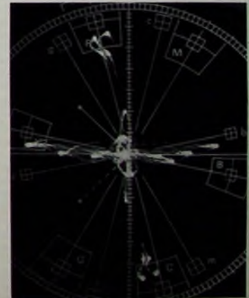
Bild 15. Vektorbild eines Farbbalkensignals mit großen differentiellen Phasenfehlern an den Ausgängen des Laufzeitmodulators
