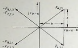
Bild 4. Zeigerdarstellung eines Farbsignals F , dessen (R-Y) -Anteil in der folgenden Zeile um 180° geschaltet wurde
