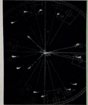
Bild 14. Vektorbild eines Farbbalkensignals mit großen differentiellen Phasenfehlern am Eingang des Laufzeitmodulators
