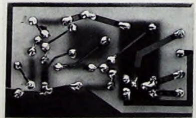
Bild 4. Gedruckte Schaltung der Platine (auf das 0,84fache verkleinert)
