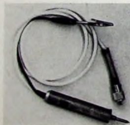
Bild 14. Spannungsteiler-Tastkopf mit eingebautem Schiebeshalter
