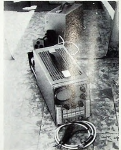
Bild 17. Gesamtansicht des Oszillografen; der Spiegel im Hintergrund zeigt den halb herausgezogenen Netzteileneinschub
