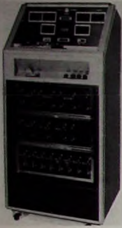
Bild 2. Verdrahtungsprüfgerät „ACT Mk. II“ von Marconi mit in Lochstreifen gespeicherten Programmen
