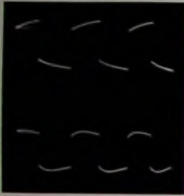
Bild 40. Andere Oszillogrammlarmen bei nicht gut eingestellter Kompensation eines Abschwächers
