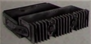
Der Autoempfänger „A 130 Stern Transit“ für UKML ist ein Zweiblockgerät; in den Bildern ist die NF-Stufe am Steuerteil angeflanscht (VEB Stern-Radio Berlin)
