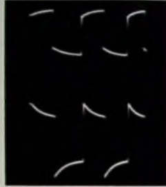
Bild 39 Bilder, wie sie bei nicht gut frequenzkompensierten Spannungsteilern auftreten; hier ist die Bedingung der Zeitkonstantengleichheit nicht erfüllt
