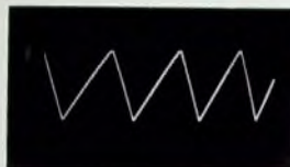
Bild 56. Oszillogramm einer zeitlinearen Kippspannung mit sehr langem Rücklauf, der beinahe die Länge des Hinlaufs erreicht; es entsteht fast eine Dreieckschwingung
