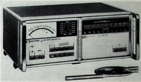
Bild 1. Präzisions-Impulsschallpegelmesser „8052 A“ (links) zusammen mit dem Oktavfilter „8055 A“ in gemeinsamem Gehäuse; im Vordergrund das Kondensatormikrofon „15118 A“ mit FET-Verstärker
