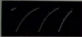
Bild 60 Wirkung von Synchronisierimpulsen auf eine Kippschwingung: erst jeweils der vierte Impuls löst den Rücklauf der Kippschwingung aus, da die Spannung erst dann auf einen genügenden, zum Rücklauf ausreichenden Wert gestiegen ist
