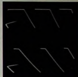
Bild 63. Typisches Oszillogramm für eine getriggerte Zeitablenkspannung. Man erkennt deutlich die Wartezeit und den Hinlauf. Der Rücklauf ist so kurz, daß er im Oszillogramm kaum nach zu sehen ist; der Hinlauf verläuft streng zeitlinear.
