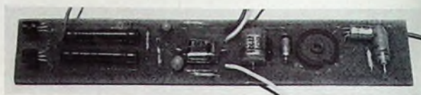
Bild 6. Bestückungsseite der gedruckten Schaltungsplatte (Stereo-Ausführung)
