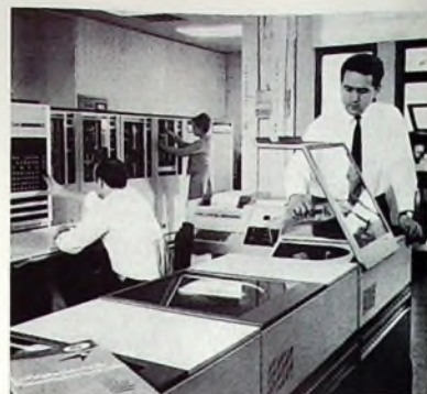
Großrechenanlage der Arbeitsgemeinschaft DVL-RIB in Stuttgart. Die Zentraleinheit „4004/55“ (links) ist das größte und leistungsfähigste Modell des Siemens-Systems „4004“. Die Anlage ist mit 2 Magnetenband-Zwillinggeräten, Bedienungstisch, mit Blattschreiber (Mitte), 4 Magnetenplattenspeichern (im Vordergrund) und Schnelldrucker (rechts hinten) ausgestattet.
