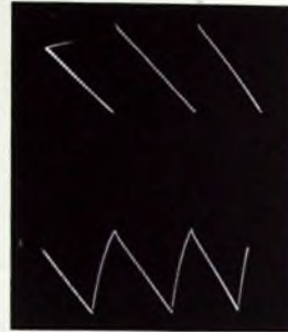
Bild 78. Typischer Kurvenverlauf an der Anode eines Miller-Transitrons; oberes Bild: Rücklauf sehr kurz; unteres Bild: Rücklauf verlängert
