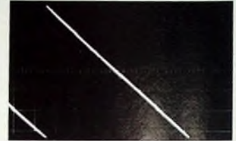
Bild 2. Oszillogramm eines 1-kHz-Sägezahns
