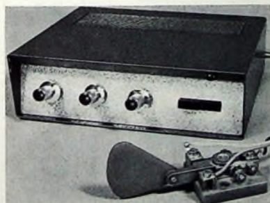
Bild 1. Gesamtansicht der elektronischen Morsetaste
