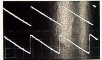
Bild 3. Sägezähne von 10 kHz (oben) und von 100 kHz (unten) bei unzureichender Abschirmung zwischen der Integrationschaltung und dem Oszillator zur Erzeugung des Steuersignals
