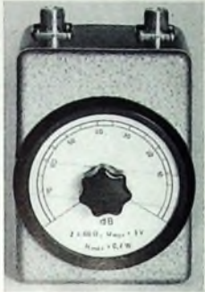
Bild 3. Dämpfungsregler mit HF-Spannungsteiler „65“ in einem Stahlblechgehäuse eingebaut
