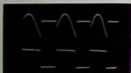
Bild 91. Obere Kurve: Spannung am Katodenwiderstand eines Schmitt-Triggers (die Hysterese ist deutlich erkennbar); untere Kurve: Ausgangsspannung an der Anode des Schmitt-Triggers
