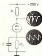
Bild 1. Der Lawineneffekt läßt sich in seiner Wirkungsweise mit einer Glimmröhrenkippschaltung vergleichen
