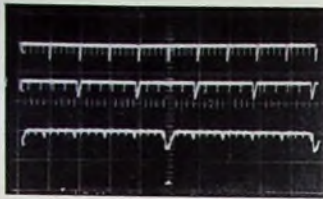
Bild 7. Zur Prüfung der Ablenkeigenschaften eines Oszilloskops wurde ein im beschriebenen Verfahren gewonnenes Impulsgemisch (Folgezeiten von 100 und 20 \mu s) bei drei aufeinanderfolgenden Stellungen des Zeitbasisumschalters aufgenommen; die untere Skala enthält zusätzlich 5- \mu s-Impulse
