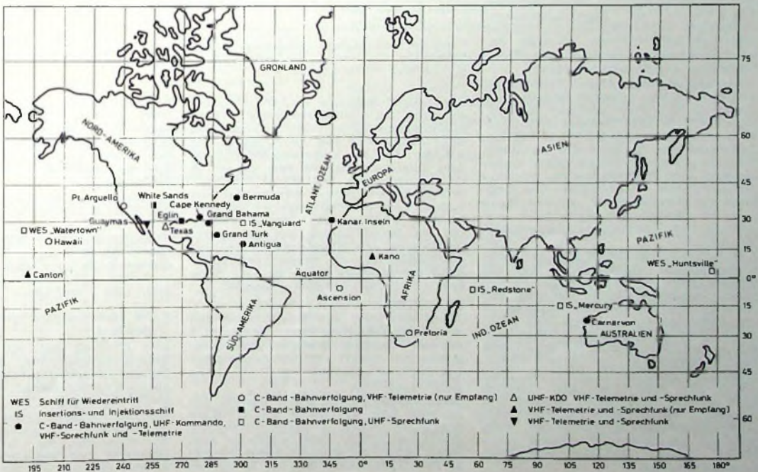
Bild 6. Das „Manned Space Flight Network“ der NASA; Positionen der VHF/UHF/C-Band-Stationen
