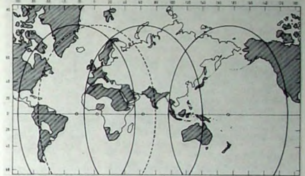
Bild 4. Positionen und Sichtbereiche von vier Synchronsatelliten des Intelsat-III-Systems
