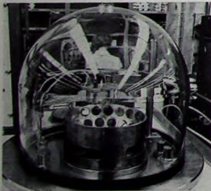
Bild 4. Auldampfen der elektrischen Leitungswege
