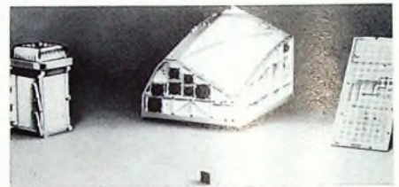
Bild 4. Der Führungsrechner, dessen barocke Form auf Einbaugründen beruht; im Vordergrund eine der zum Bau des Rechners verwendeten Mikroschalt- Baugruppen, die auf den gedruckten Schaltplatten (rechts) untergebracht sind (Aufnahme IBM)
