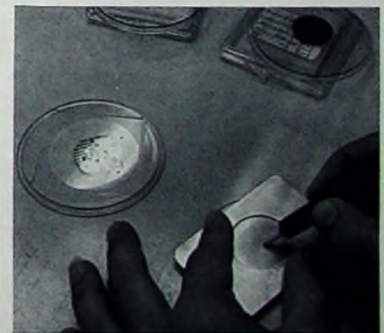
Bild 9. Trennung der einzelnen Schaltungen
