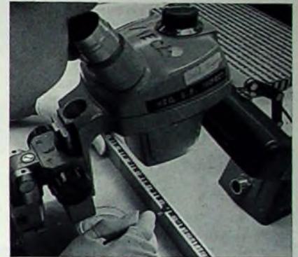
Bild 11. Kontrolle der Verbindung mit der Grundplatte
