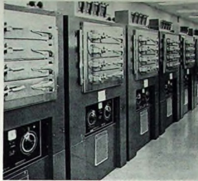
Bild 13. Die Öfen für den Ausbrennprozess
