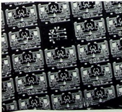
Bild 7. Ausschnitt aus einer Siliziumscheibe mit fertigen integrierten Schaltungen
