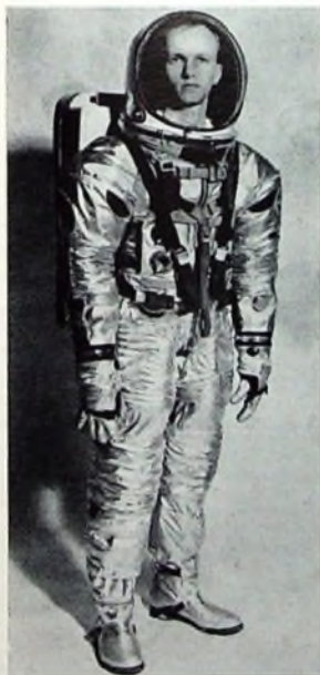
Bild 9. Die neueste Version der Apollo-Raumanzüge mit dem auf dem Rücken befindlichen „Lebenserhaltungssystem“, das dem Astronauten den Aufenthalt auf der atmosphärenlosen Mondoberfläche ermöglicht; gleichzeitig sorgt es für entsprechende Temperaturerem im Innern des Raumanzuges
