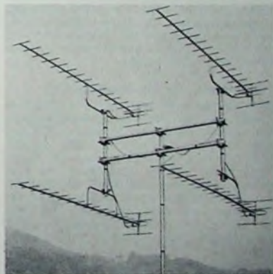
Bild 21. Mehrfach-Antennenanordnung aus vier UHF-Antennen in zwei Zeilen und zwei Spalten mit optimalen gegenseitigen Abständen als Hochleistungs-Antennenanlage
