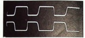
Bild 126. Zweistrahl-Oszillogramm mit Zeitablenkung (Rechteckspannungen)
