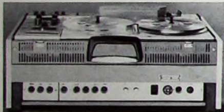
Bild 5. Versenkte Anordnung der Anschlußbuchsen
