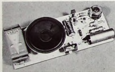
Bild 3. Gesamtansicht des Geiger-Müller-Zählers
