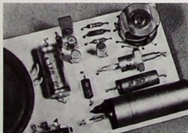
Bild 4. Blick auf die Einzelteile: rechts unten liegt das Zählrohr
