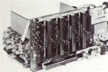
Bild 7. Die Flachbahnregler sind direkt auf der Vorverstärkerplatine des „STG 2091“ angeordnet
