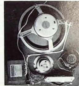
Bild 4. Rückseite der Schallwand mit montierten Bauteilen
