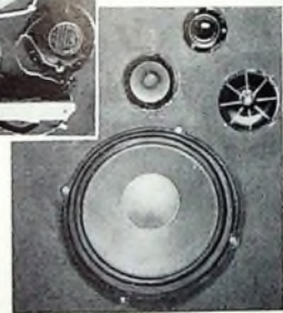
Bild 4. Rückseite der Schallwand mit montierten Bauteilen
