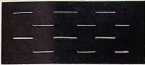
Bild 12. Ergebnis der Rechteckspannungsprüfung an einem Verstärker mit sehr tiefer unterer Grenzfrequenz; oben: Originalsignal, unten: Ausgangssignal des Verstärkers
