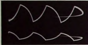
Bild 17. Ausgangsspannung eines Verstärkers bei tiefer oberer Grenzfrequenz; obere Kurve: Spannung an der Anode, untere Kurve: Spannung an der Kathode der Röhre
