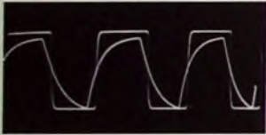
Bild 18. Vergleich zwischen der Eingangs-Rechteckspannung und der Ausgangsspannung bei relativ tiefer oberer Grenzfrequenz; zwischen beiden Spannungen besteht eine kleine Phasenverschiebung
