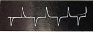
Bild 14. Wie Bild 13, jedoch untere Grenzfrequenz nach höher; die Kurve wird bereits weitgehend differenziert
