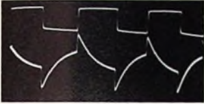
Bild 13. Verhalten eines Verstärkers bei der Prüfung mit Rechteckspannungen (untere Grenzfrequenz relativ hoch); obere Kurve: Rechteck-Eingangsspannung, untere Kurve: Ausgangsspannung (die Dachschräge ist sehr groß)
