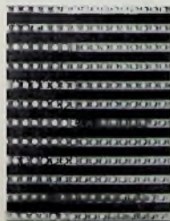
Bild 1. Teilansicht einer im Original („M8“) 165 mm x 90 mm großen „Veroboard“-Platte mit 18 etwa 2,5 mm breiten Leiterbahnen
