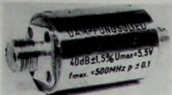
Bild 3. 40-dB-Dämpfungsglied in Koaxialbauweise
