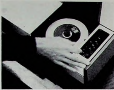
Bild 2. EVR-Teleplayer mit eingelegerter Kassette und Bedienfeld
