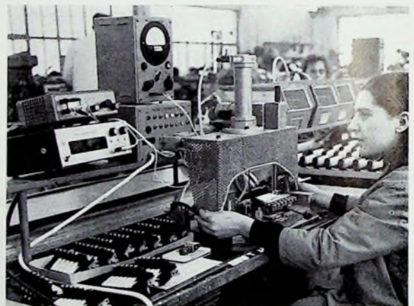
Halbautomatischer Prüfplatz für den Widerstandsabgleich in der „Preomat“-Montage
