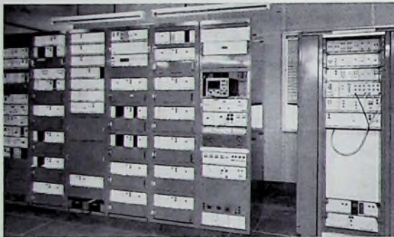
Normwandlergestell der BBC zur Umsetzung des NTSC-Farbfernsehsignals in die PAL-Norm
