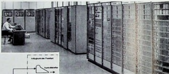
Ansicht und Funktionsschema des Doppelrechnersystems (1. Ausbaustufe des Systems)
