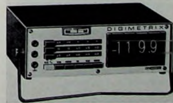
Bild 2. „Digimetrix DX 703 A“, ein digitales Werkstatt-Vielfachgerät von Metrix
