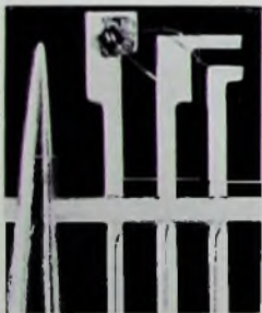
Bild 1. Nach unvergossene Plastiktransistoren von AEG-Telefunken im Vergleich zu einer Nadelspitze (etwa sechsfache Vergrößerung). Das eigentliche Transistorsystem ist auf dem einen Anschlußleiter befestigt und mittels haarfeiner Drähte mit den anderen Anschlußleitern verbunden.
