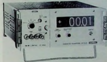
Bild 3. Gleichspannungsvoltmeter von Metrix mit digitaler Anzeige
