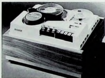
Bild 1. Videorecorder „BK 100“ von Grundig; Edelholzschauble mit (im Bild abgenommener) Klarsicht-Abdeckhaube
