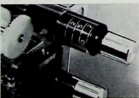
Bild 11. Abstimmknopf mit Skala einer zweiten Variante des „electronic“-Tuners von Grundig
