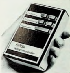
Bild 18. Steuergerät der Ultraschall-Fernbedienung „telecommander“ für das Saba-Farbfernsehgerät „Schauinsland T 3000“
