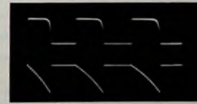
Bild 105. Sehr starke Verformungen eines Rechteckoszillogramms bei Transistoren mit sehr tiefer oberer Grenzfrequenz
