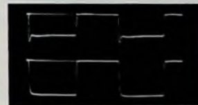
Bild 103. Trägheiterscheinungen bei einem Transistor mit höherer Grenzfrequenz gegenüber Bild 102
