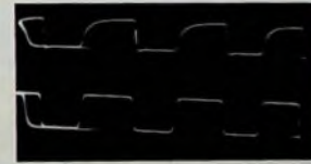
Bild 104. Verformung der Anstiegsflanke von Rechteckschwingungen bei Transistoren, deren Grenzfrequenz nicht ausreicht
