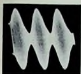
Bild 110. Oszillogramm einer modulierten Schwingung
