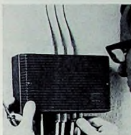
Bild 8. Mehrbereichsverstärker „SAV 32032“ von Siemens für kleine bis mittlere Gemeinschafts-Antennenanlagen
