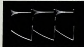
Bild 117. Darstellung gedämpfter Schwingungen, Schwingkreis durch den Rücklauf einer Kippspannung angestoßen
