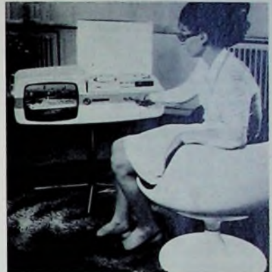
Bild 15 Mögliche Zusammenfassung eines Video-Recorders „LDL 1000“ und eines 31 cm Schwarz-Weiß-Empfängers (Philips)
