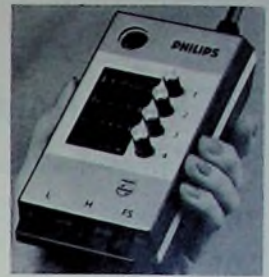
Bild 13 Seitlich herausklappbare Konvergenzleiste des Farbfernsehempfängers „Goya SL“ von Philips
