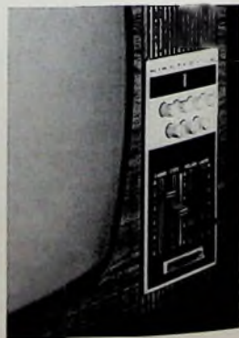
Bild 5. Die neuen Grundig-Farbfernsehempfänger haben eine übersichtliche Bedienungsleiste mit Flachbahn-Schiebereglern
