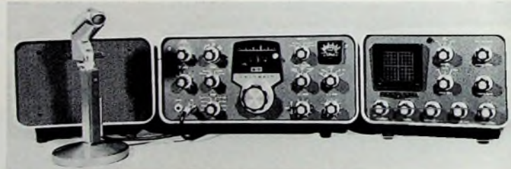
Bild 13. Die komplette Amateurfunkanlage der Spitzenklasse zeigt in der Mitte den SSB/CW-Transceiver „SB-101“; rechts schließt sich der Stationsmonitor „SB-610 E“ an, und links ist der Stationslautsprecher „SB-600“ mit eingebautem Universalnetzteil „HP-23 E“ angeordnet. Das davor stehende SSB-Mikrofon „HDP-21 A“ sorgt für einwandfreie Sprachübertragung
