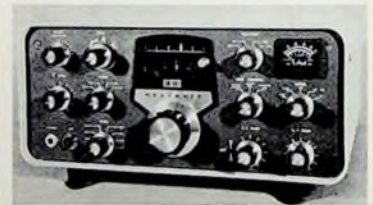
▲ Bild 1. Blick auf die Bedienelemente des Transceivers; links die Abstimmung des Sendeteils (z.B. Treiber, PA, Antenne, Mikrofonpegel) und rechts die Umschaltung des Meßwerkes mit S-Meter, HF-Regler und Lautstärkereglern
