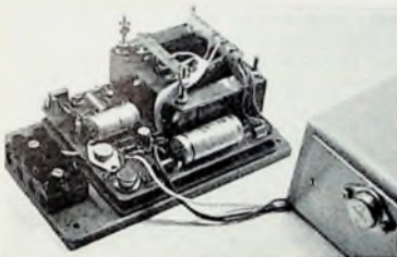
Bild 6. Aufbau der Anlage; außen am Gehäuse der Leistungstransistor T6 mit Kühlblech
