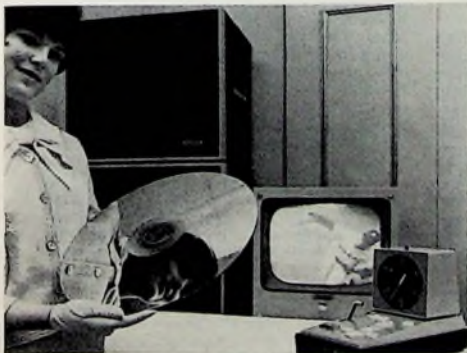
Bild 9a. Speicherplatte der Ampex-Zeillupengeräte: im Hintergrund links befindet sich der Plattenspeicher „HS-100“, rechts im Vordergrund das Bedienungspult
