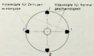
Bild 12. Modifiziertes Kopfrad des Video-Recorders „VR 650“
